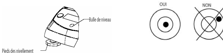
Figure 2-1. Mise à niveau de la balance.
